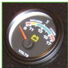
Battery volt meter
